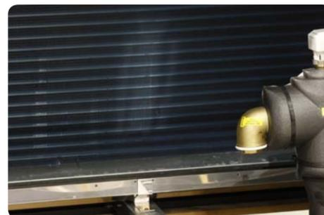
Alle Modelle des Sortiments **TREF Free-Cooling** sind serienmäßig mit Wärmeaustauschregister mit hydrophiler Behandlung ausgestattet. Die spezielle Verkleidung und eine angemessene Wahl der Durchquerungsgeschwindigkeit des Luftstromes begünstigen das Aufnehmen des Kondenswassers im Entfeuchtungsprozess, wodurch das Nachziehen von Tropfen inner- und außerhalb der Einheit vermieden wird.
